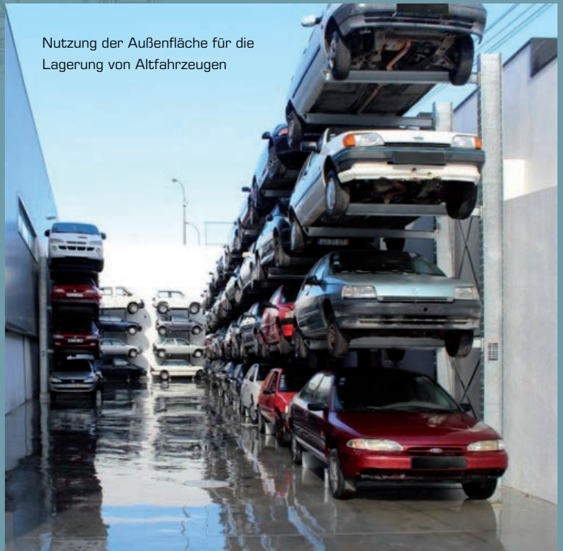
Lagerkonzeption mit Schmalgang, Führungsschiene und Ständerbrücken
