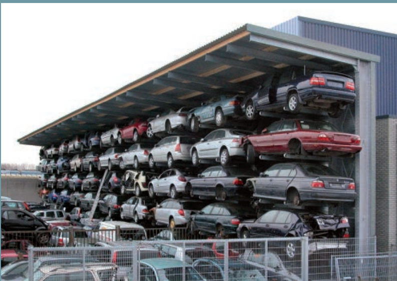
50 Fahrzeuge, gelagert in robusten Kragarmregalen mit Dach. Hohe Lagerdichte auf geringer Grundfläche. Übersichtliche Lagerung und schneller Zugriff auf alle Modelle.
