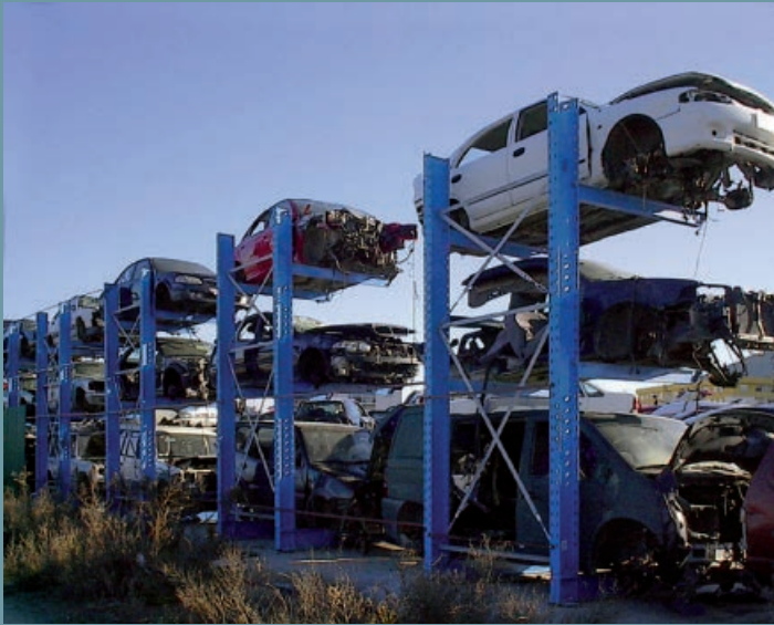
Kompakte Kragarmregale für die Lagerung von Altfahrzeugen im Freigelände. Keine versteckte Rostbildung wie bei Kastenprofilen durch den Einsatz von vollwandigen Stahlprofilen.
