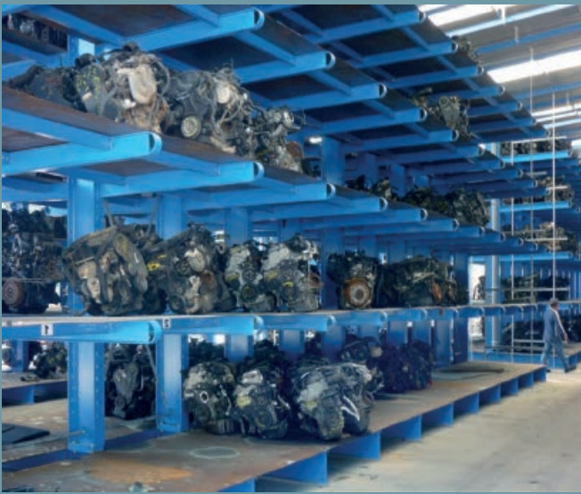
Lagerung von Motoren in robusten Kragarmregalen. Durch den Einsatz von Armbrücken kann eine Vielzahl von unterschiedlichen Größen in einer Ebene gelagert werden.
