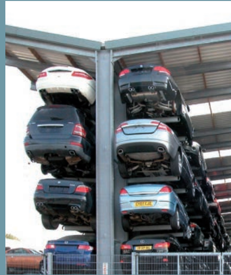
Einzelne Regalzeilen können teilweise oder komplett überdacht werden. Dabei werden Schnee- und Windlasten bei der Kalkulation berücksichtigt.
