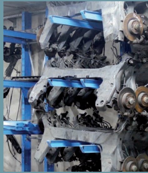
Lagerung von Fahrzeugachsen in Kragarmregalen. Die Abstände der Stützen sind variabel und die Lagerebenen in der Höhe verstellbar.
