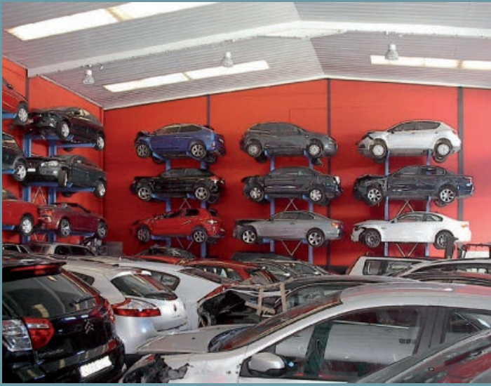
Übersichtliche Lagerung mehrerer Fahrzeuge übereinander. Ausnutzung der vorhandenen Raumhöhe und Wandfläche.
